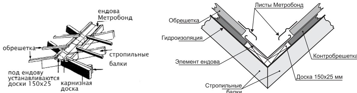
На доски сечением 25x150 мм крепят гвоздями элементы ендова снизу вверх, начиная от карниза. Нахлест 100 мм. Гвозди забивают на максимально возможном расстоянии от линии ендовы и на расстоянии 30 мм от ее верхнего края. Каждый последующий элемент вдвигают в предыдущий и также крепят гвоздями. Элемент ендова поставляется **без каменной посыпки**.
