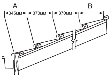
Размер А зависит от вида применяемой водосточной системы. Его выбирают так, чтобы вода с нижнего листа **Метробонд (Metrobond)** попадала в водосточный желоб и при сильном, и при слабом дожде. Обычно А=345 мм. Размер В зависит от длины стропила. Оптимальной длиной стропила является такая его длина, при которой В=370 мм, что соответствует целому листу **Метробонд (Metrobond)**.
