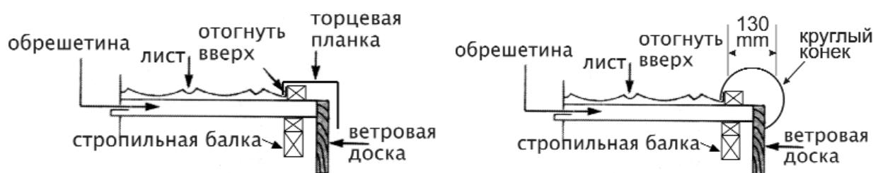
Края торцевой планки в местах пересечения с ребровым или полукруглым коньком следует надрезать, загнуть и завести под коньковый элемент.
