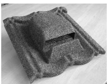
Для достижения рекомендуемой величины воздушного потока кровельные вентиляторы должны устанавливаться около конька по одному на каждые 50-70 кв.м. поверхности кровли. Наряду с обеспечением эффективной вентиляции кровельные вентиляторы препятствуют проникновению в уязвимые чердачные помещения дождевой воды, снега и птиц.
